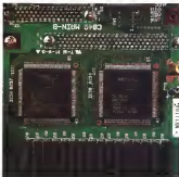
La matrice di processori in tecnologia RISC della WinJet che controllano il cuore della stampante Epson EPL 7100.
